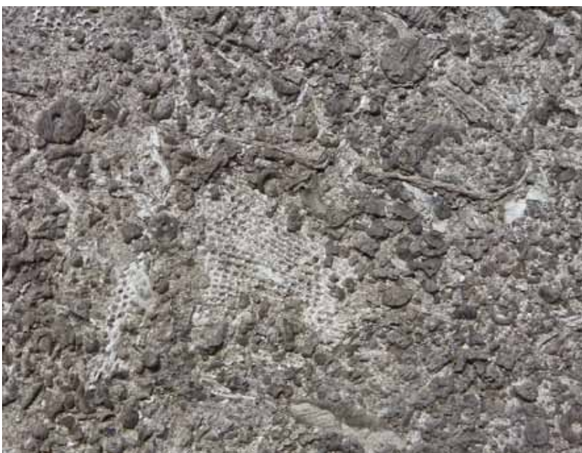
Fossiele bryozoën in Belgisch hardsteen. Hier is het niet gepolijst ("gezoet") zodat het gemakkelijk verweerde. Het uiterlijk is niet zwart en glad maar grijs en ruw.
